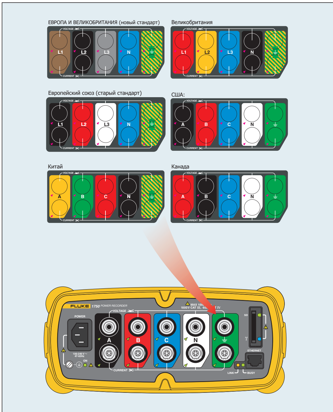
Рис. 2. Наклеивание наклейки на переднюю панель
