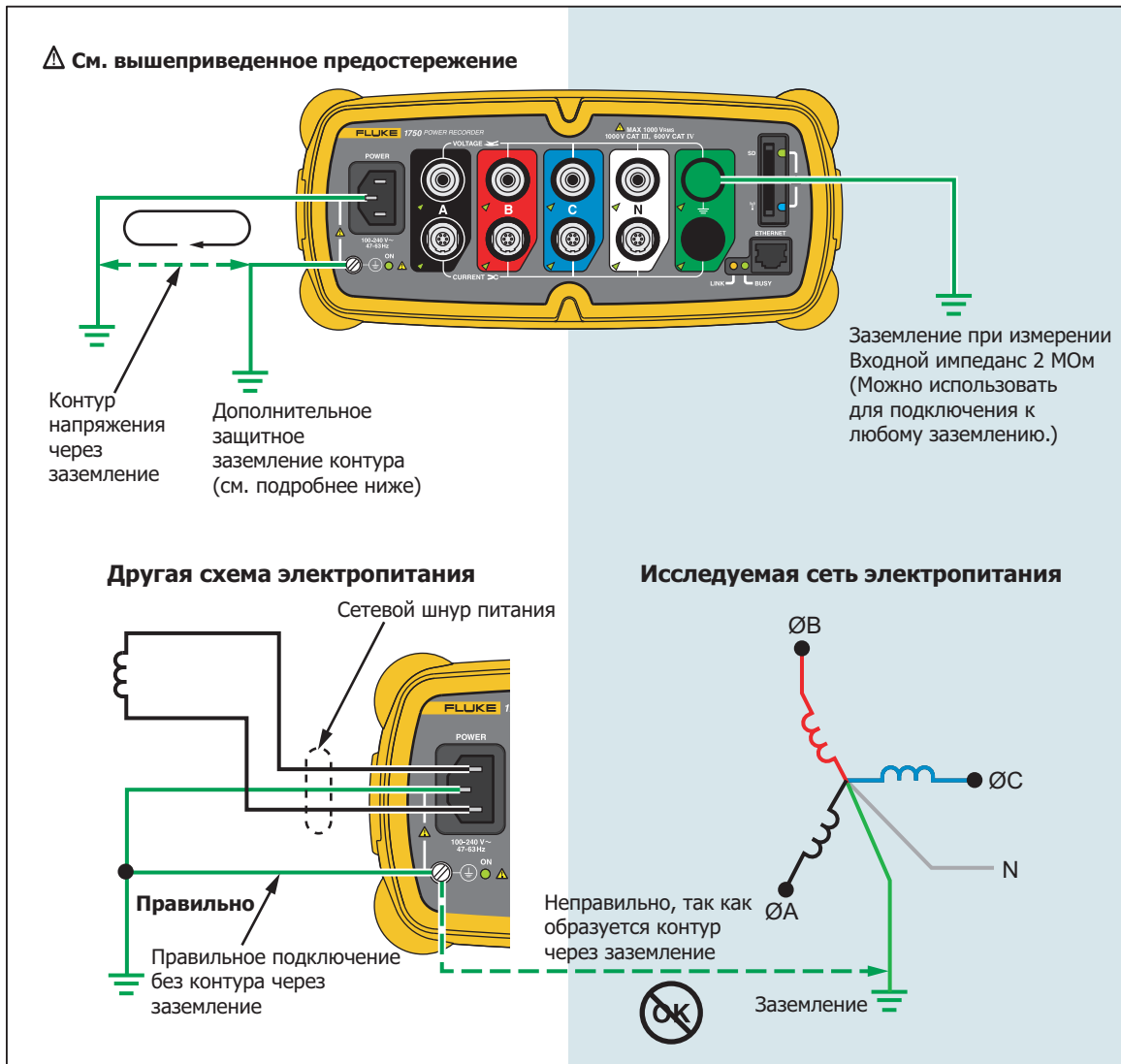
Рис. 3. Подключение дополнительной клеммы заземления
